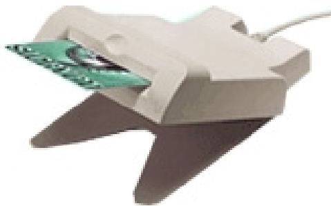
7. ábra. Kártyaolvasó - ez kapcsolja össze a PC-t a smart carddal.
